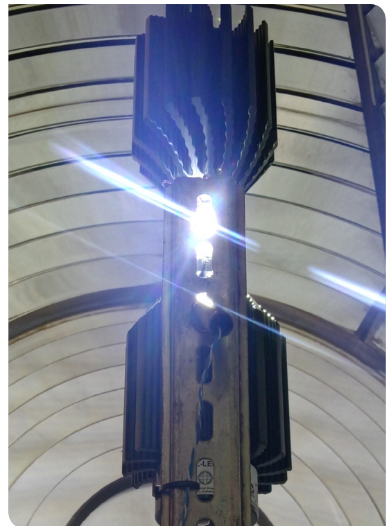
Fuente de Luz LED desarrollada originalmente por GLA R&R NAV, dirigida y fabricada bajo la licencia de Trinity House.
